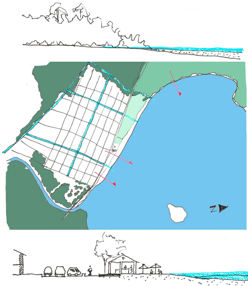
Figura 61: UP03 - Jabaquara - Cenário Existente – assoreamento junto ao mangue e erosão junto ao rio Jabaquara – quiosques e mobiliário presente em faixa de areia
